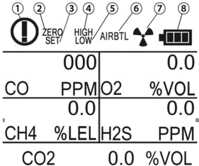
Рис.2 Дисплей газоанализатора ГАНК-П4
