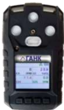
а) газоанализатор ГАНК, модификация ГАНК-П1
