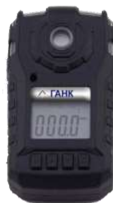
б) газоанализатор ГАНК, модификация ГАНК-П2
