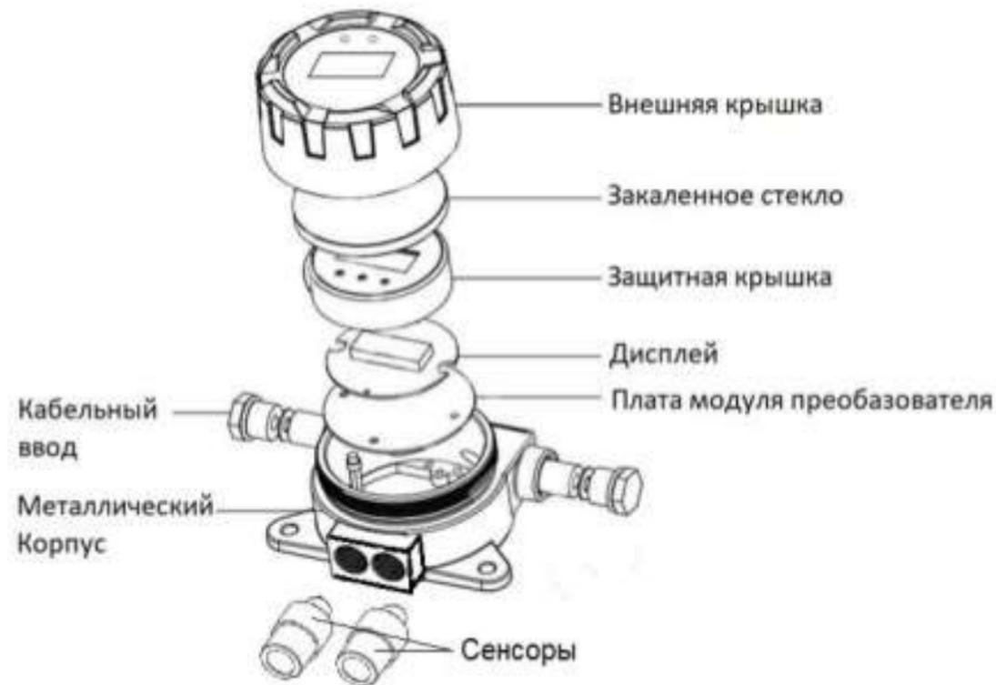
Рисунок 3 – Конструкция газоанализатора
