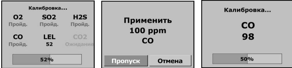
После завершения калибровки на дисплей выводится диалоговое окно с сообщениями о результатах калибровки (пройдена, не пройдена, предельное значение и пропущена) (на следующем рисунке показан пример для газоанализатора с шестью датчиками).
