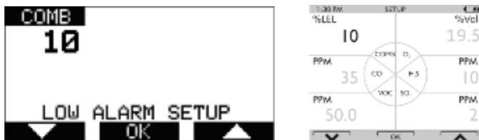
рисунок 10 Настройка сигнализации от датчиков
