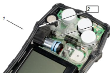
рисунок 15 Датчики, которые можно заменять
