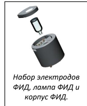
При необходимости, если при выполнении ударных испытаний или калибровки наблюдается неожиданная потеря чувствительности, лампу MiniPID следует очистить или заменить. Следует отметить, что воздействие на датчик аминов может привести к загрязнению лампы ФИД. Для предотвращения загрязнения необходимо использовать приборы соответствующей конструкции.
